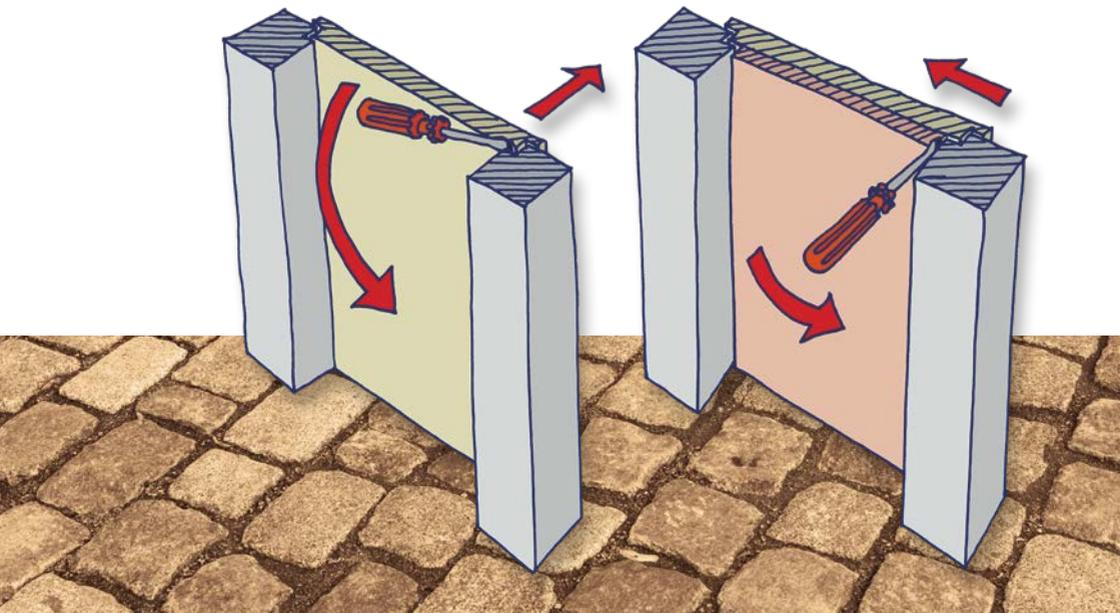
*Wenn die Aussenseite einer Tür mit einer zusätzlichen Holzplatte verstärkt wird, kann der Hebel nicht mehr zwischen Tür und Rahmeninnenseite (Zeichnung links) angesetzt werden, sondern nur noch – völlig wirkungslos! – zwischen Rahmen und Holzplatte (Zeichnung rechts).*
