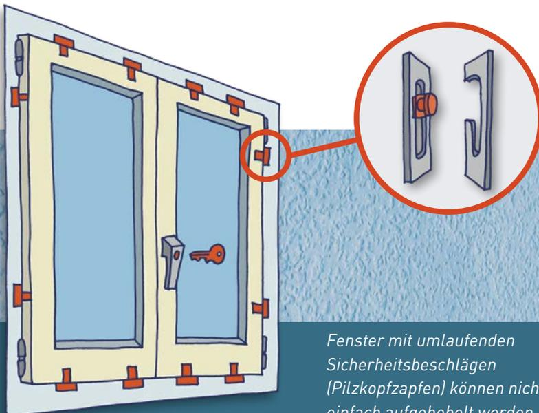
*Fenster mit umlaufenden Sicherheitsbeschlägen (Pilzkopfzapfen) können nicht einfach aufgehebelt werden.*
